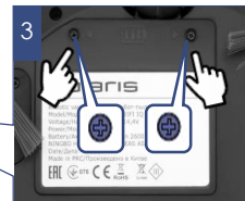
3 Батареялық бөлік қақпағының бұраншегесін бұрап шығарыңыз және қақпақты шешіп алыңыз
